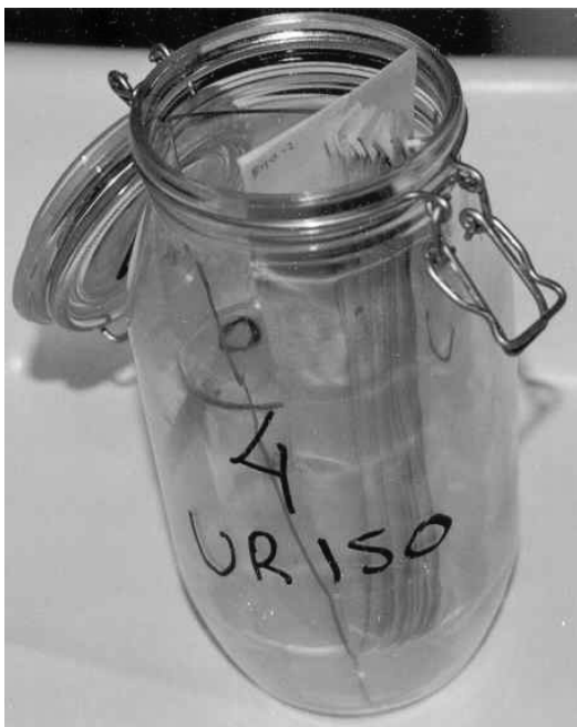
Εικόνα 75: Γυάλινο δοχείο που χρησιμοποιήθηκε για την τεχνητή γήρανση. Διακρίνεται το ποτήρι ζέσης και τα δείγματα.
