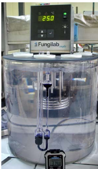
Εικόνα 2. Πειραματική διάταξη για τη μέτρηση του ιξώδους. Διακρίνονται το ιξωδόμετρο τύπου Ubbelohde, το υδρόλουτρο που έχει θερμοστατηθεί στους 25°C και το χρονόμετρο.
